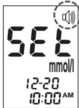
2. Pritisajte tastere i dok se na ekranu ne pojavi simbol „“. Na ekranu će treptati simboli ON/OFF za podešavanje zvučnog signala.
