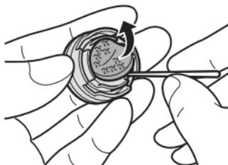
Uklonite stari filter za vazduh oštrim predmetom i ubacite novi filter.
